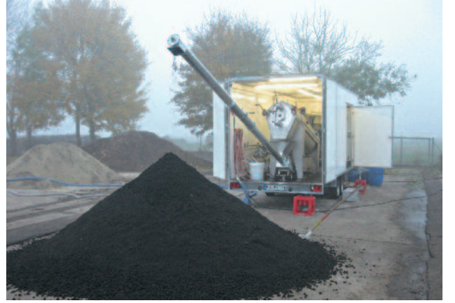
Mobil Q-PRESS® 440 ile ücret karşılığı susuzlaştırma işlemi
