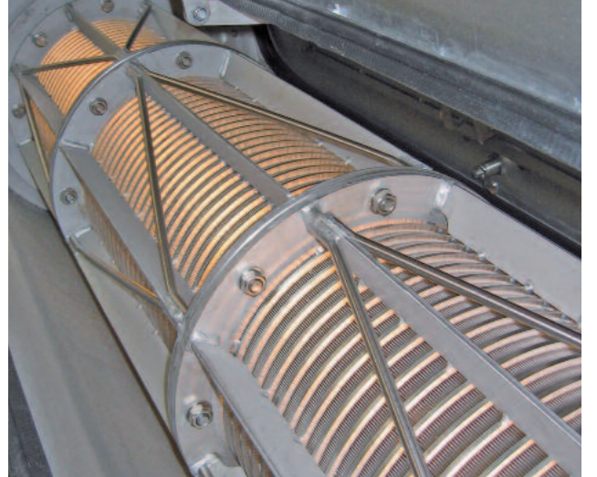
Paslanmaz çelikten imal edilmiş sağlam sepet ızgara
