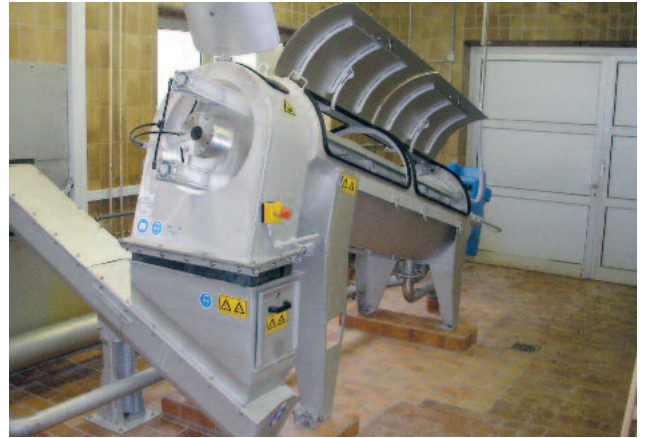
Yalnızca 12 m²'lik bir alan içine bir Q-PRESS® 440 komple kurulabilir.
