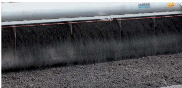
La vis de répartition permet de déposer automatiquement la boue deshydratée sur toute la largeur de la surface de séchage.
