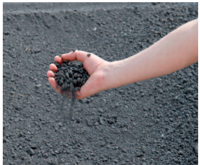
Les boues séchées deviennent des granulats.
