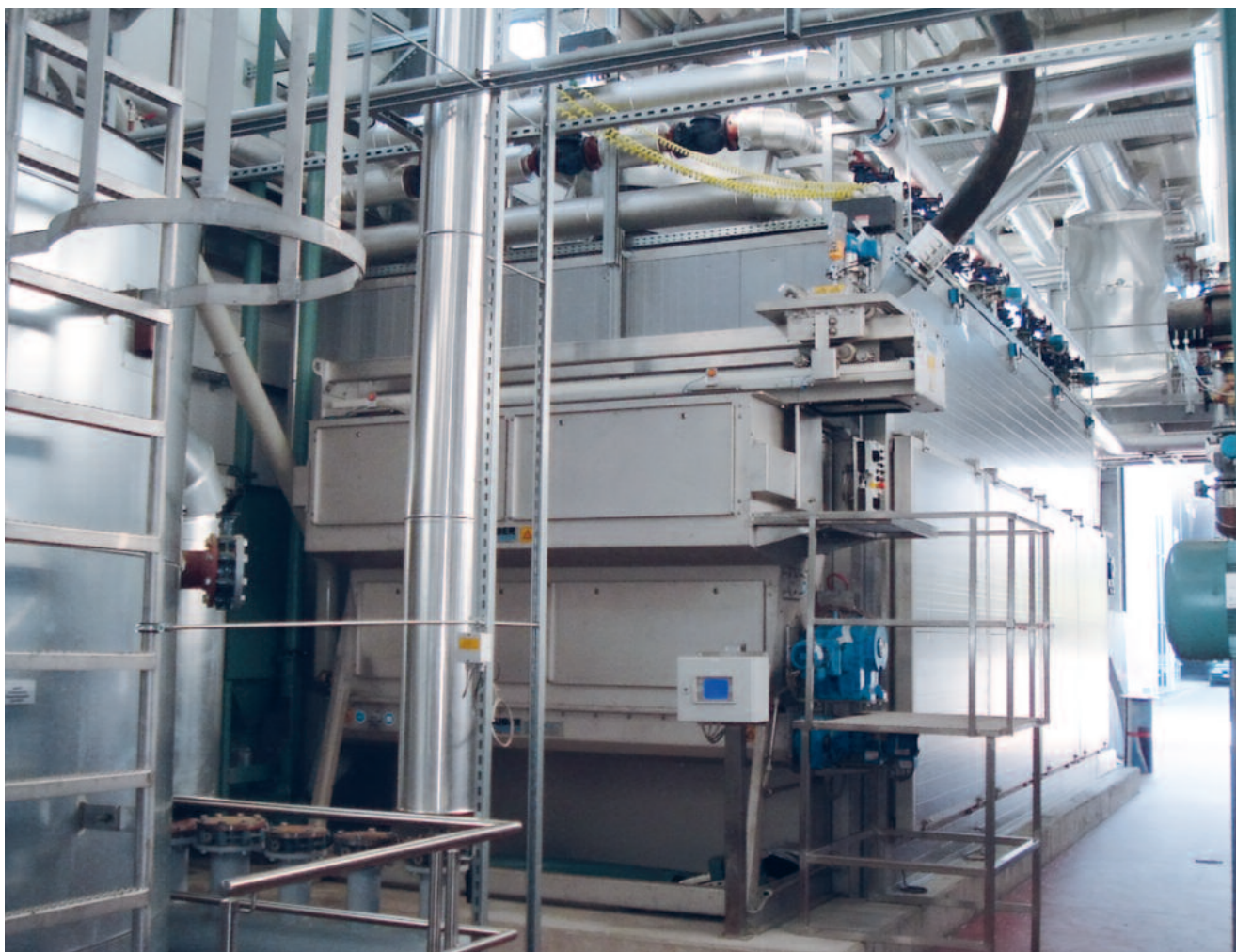
Pásová sušička HUBER BT: dávkování mokrého kalu pomocí peletizátoru a odběr suchého kalu horizontálním šnekovým dopravníkem
