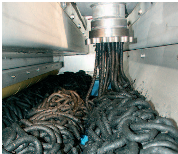
Dávkování kalu pomocí našeho peletizátoru je nezbytné pro vysokou výkonnost našich pásových sušáren.
