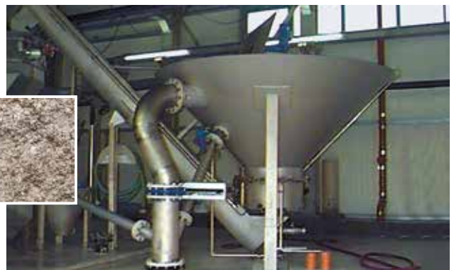
Gewaschener Sand aus der HUBER Coanda Sandwaschanlage RoSF4 mit GV < 3%, Korngröße bis 10mm, TR > 90%.
