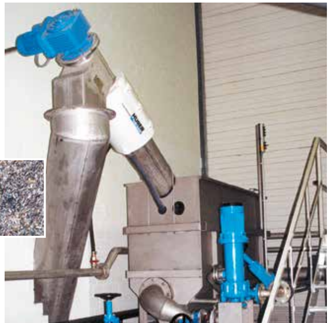
Absieben bei 1 mm und Entwässern (TR ca. 30%) der organischen Stoffe mit der HUBER Siebanlage ROTAMAT®.
