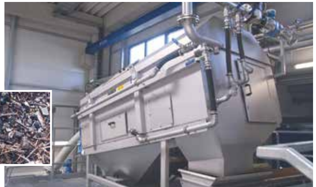
Auswaschen und Abtrennen aller Grobstoffe > 10 mm mit der HUBER Waschtrommel RoSF9.
