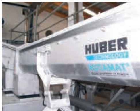
ROTAMAT® šnekový dopravník Ro 8 / Ro 8t, pro všechna dopravovaná media a možnosti dopravy
