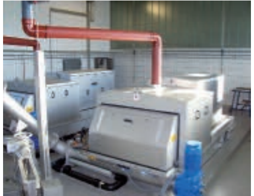
Spolehlivá separace pevných látek kompaktními česlemi CurveMax®
