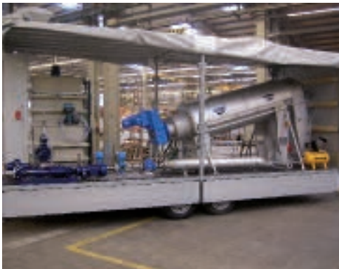
RoS 3Q šnekový lis – mobilní zařízení pro testovací účely
