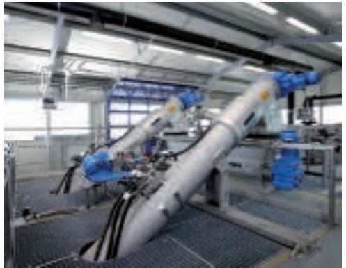
ROTAMAT® membránové síto speciálně pro odstranění vlasů a vláken
