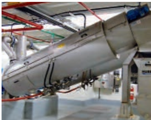
RoS 3 šnekový lis specifická spotřeba < 0,01 kWh/kg sušiny
