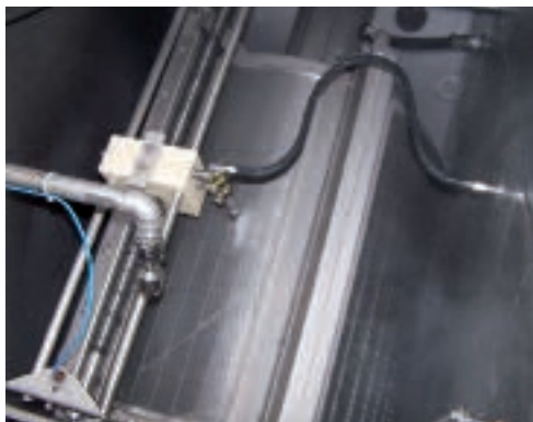
HUBER ROTAMAT® - síta Ro 2 s 1 mm jemností a pojízdným vysokotlakým čištěním
