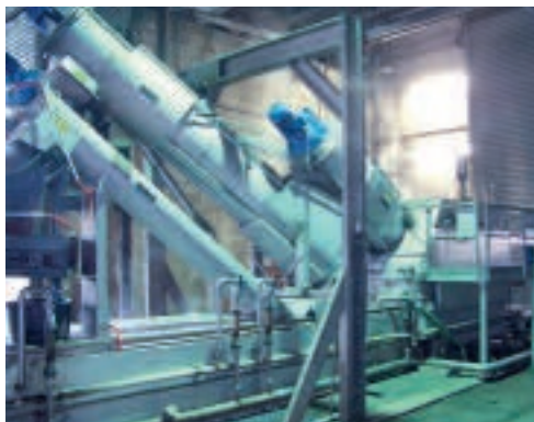
HUBER ROTAMAT® kompaktní zařízení Ro5 BIO v aplikaci při kvašení biologického odpadu
