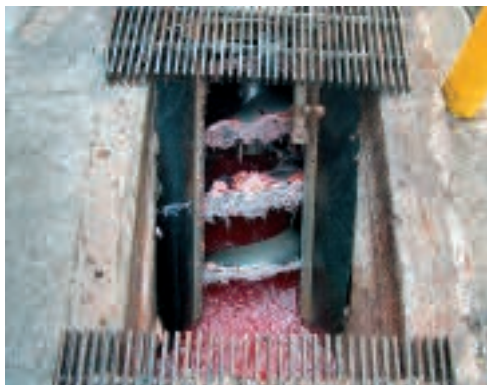
HUBER ROTAMAT® šnek se sítí Ro9 < s 3 mm sítí z děrovaného plechu
